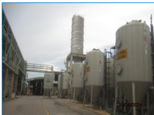
ภาพถ่ายที่ 2.2-10 Activated Carbon Adsorber ของส่วนผลิต PC
